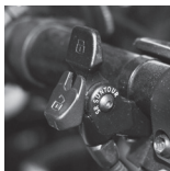
DŹWIGNIA BLOKADY SKOKU MONTOWANA NA KIEROWNICY
