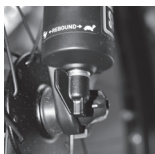
REGULACJA TŁUMIENIA AMORTYZATORA
